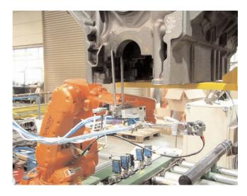
Flansch sich das Messwerkzeug befindet, werden die verschiedenen Punkte angefahren und die Messungen durchgeführt. Das Messwerkzeug besteht aus drei Komponenten:
